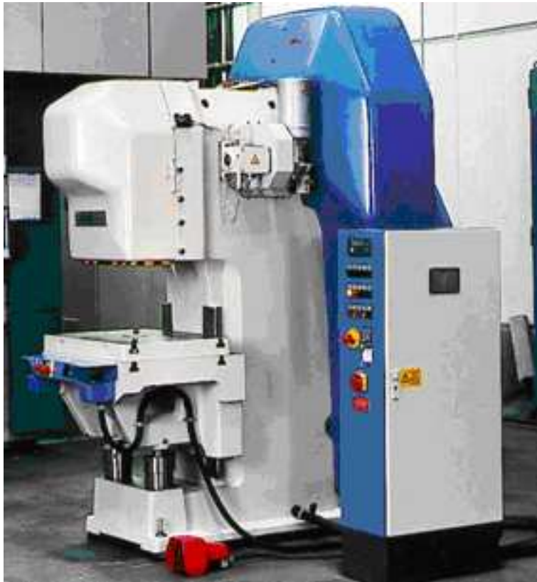
Légende 3 : Une boîte à cames électronique simplifie le fonctionnement des presses excentriques et offre des fonctions supplémentaires
