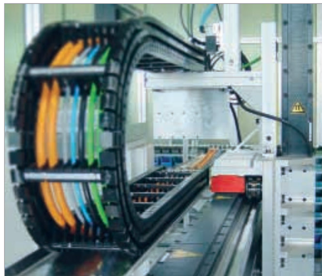
Système de chaînes porte-câbles QUANTUM sur une installation de manutention
