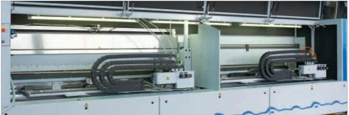
Système de chaîne porte-câbles de la série UNIFLEX sur machine à bois
