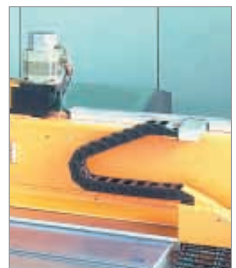
Chaînes porte-câbles de la série UNIFLEX et capotage télescopique Kabelschlepp sur un centre d'usinage haute vitesse
