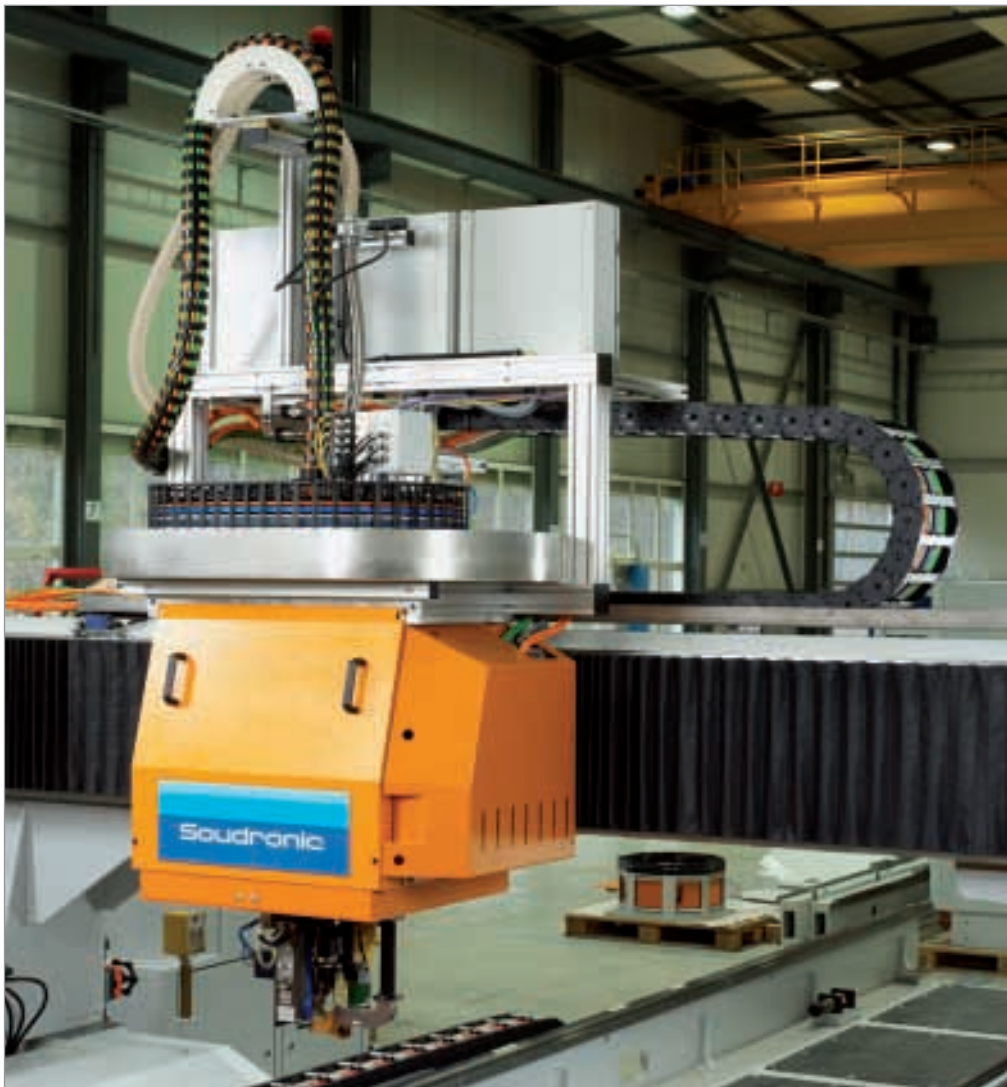
Système de chaîne porte-câbles des séries ROBOTRAX, série K et série M sur sur une machine à découpe laser Photo : Soudronic AG Automotive
