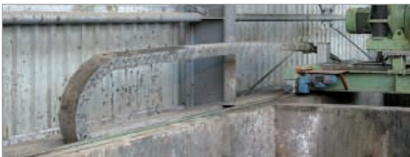
Système de chaîne porte câbles en acier avec bande de protection en acier sur une machine de broyage
