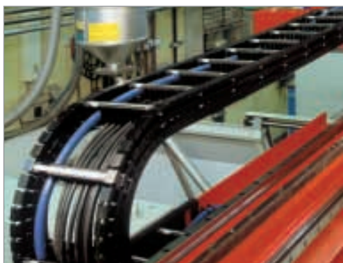
Chaînes porte-câbles de la série MONO série type 0450 Variantes de montage horizontal «auto-portant» – et vertical «debout»
