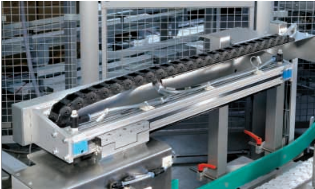
Système de chaîne porte-câbles de la série UNIFLEX sur un machine d'emballages Photos : Transnova-Ruf GmbH
