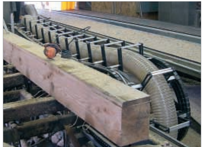
Système de chaîne porte-câbles QUANTUM sur une machine à travailler le bois
