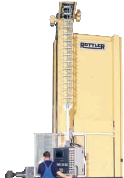
Système de chaîne porte-câbles sur une machine à commande numérique
