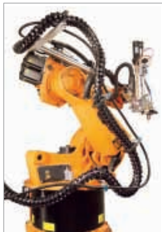
Système de chaînes porte câbles ROBOTRAX sur un robot à bras articulés Photo : SCA Schucker GmbH & Co.
