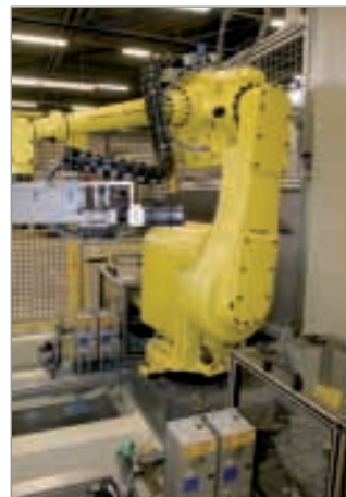
Système de chaînes porte câbles ROBOTRAX sur une machine de montage Photos : Gerstung Systemtechnik GmbH
