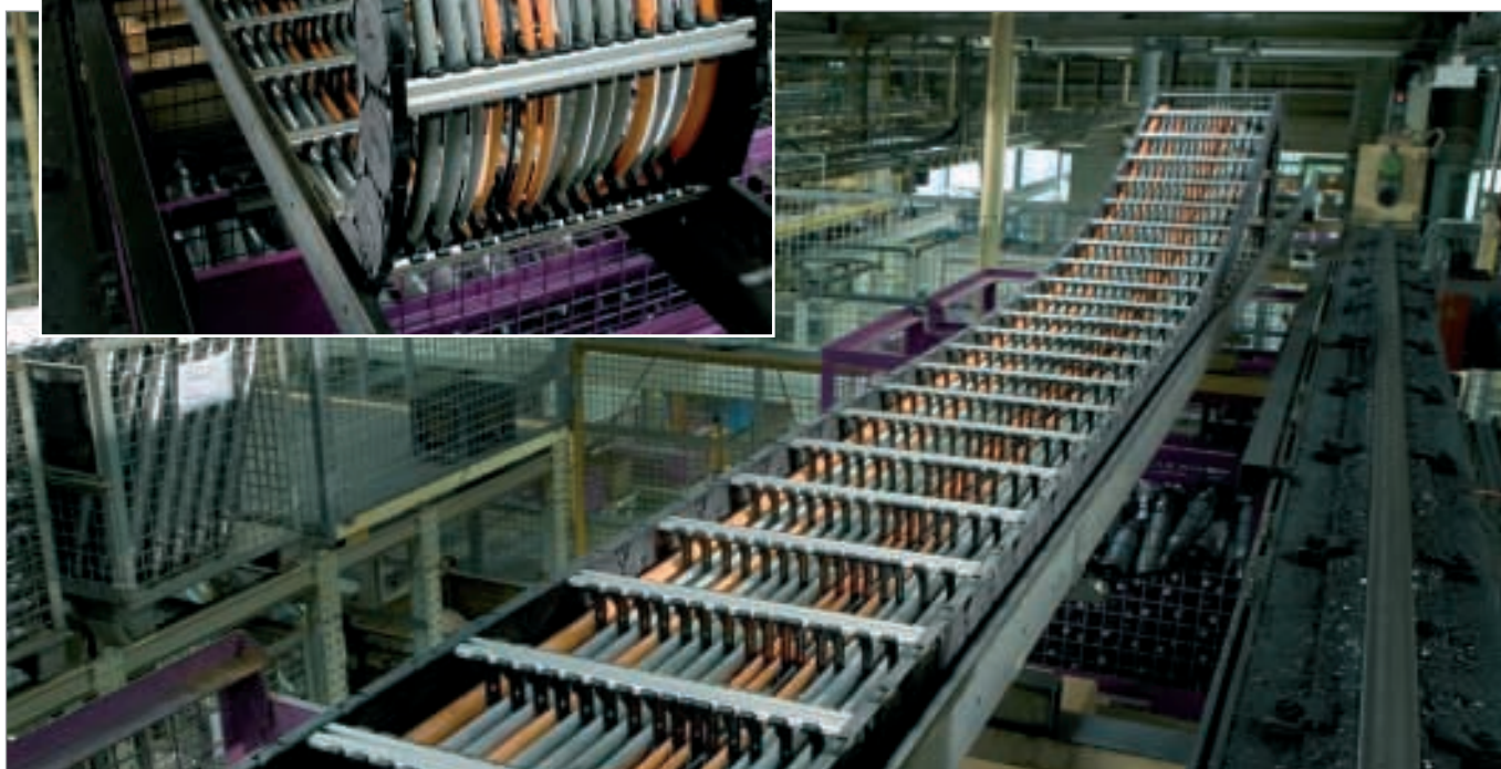
Système de chaîne porte-câbles de la série M sur étagère automatique
