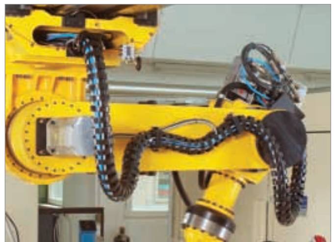
Système de chaînes porte câbles ROBOTRAX sur une machine de montage Photos : Gerstung Systemtechnik GmbH
