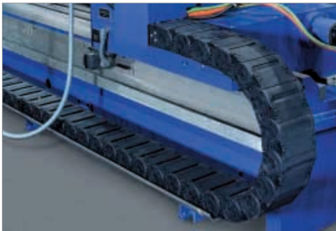
Chaînes porte-câble série type MT 0950 sur une machine de rectification Variante de montage : horizontal – «auto-portant» Photo : Waldrich Siegen Werkzeugmaschinen GmbH
