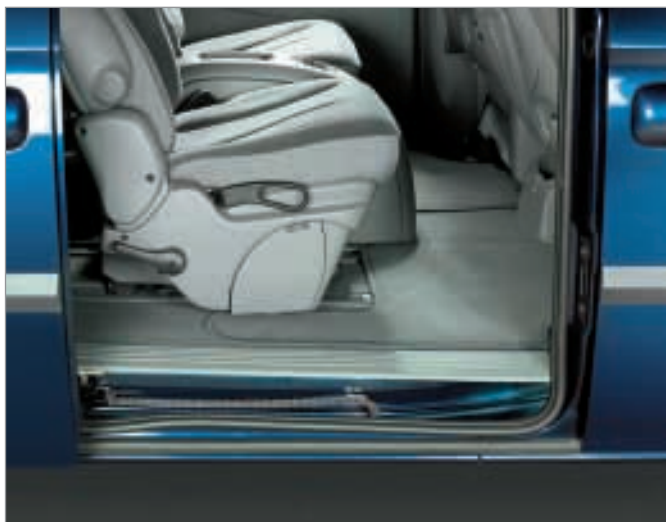
Chaînes porte-câbles série type 0161 dans une porte coulissante de véhicule automobile
