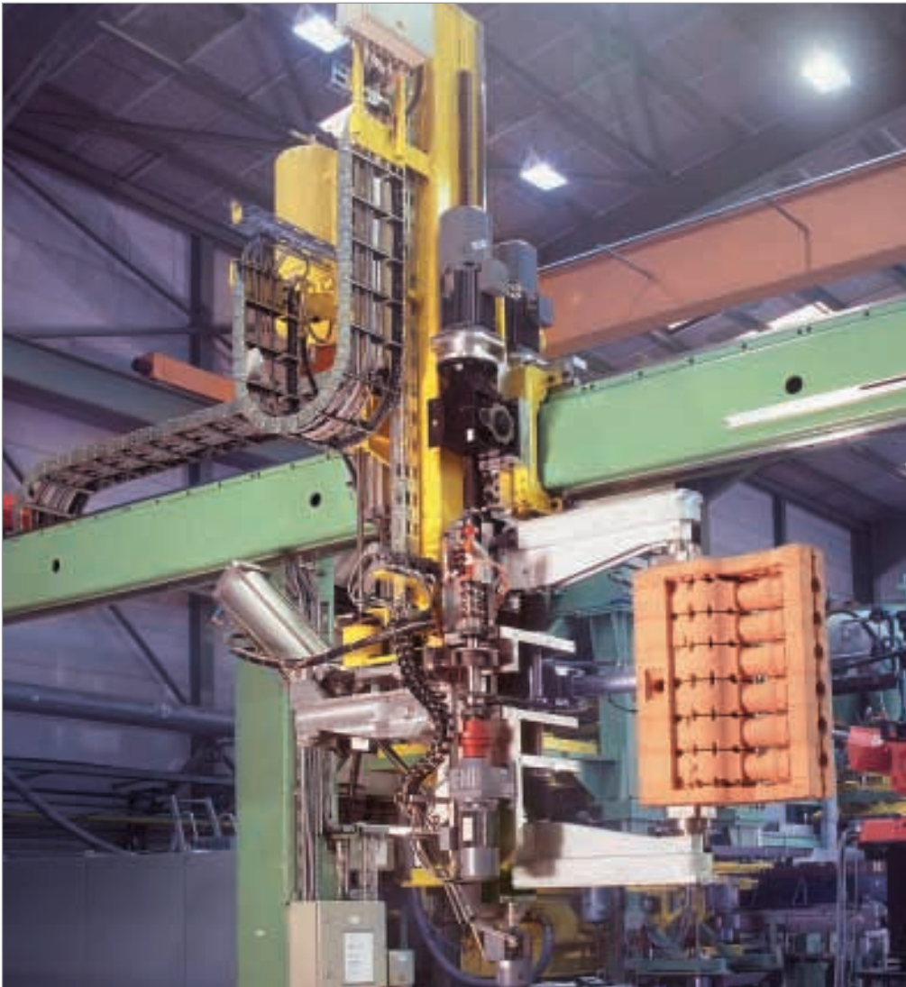
Système de porte-câbles ROBOTRAX et chaînes porte-câbles en acier sur une installation de manutention
