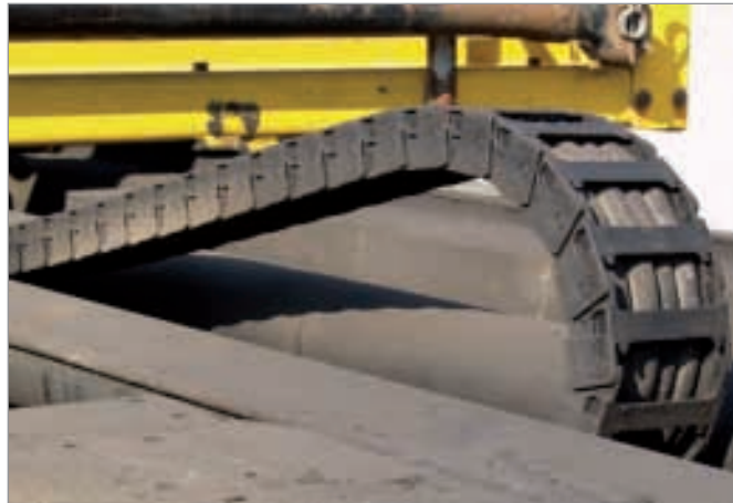
Système de chaîne porte-câbles des séries UNIFLEX et MONO sur camion de remorquage
