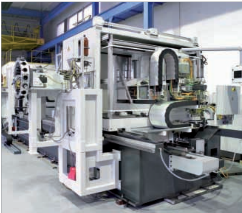
Système de chaîne porte-câbles de la série MASTER LT sur machine à fabriquer des tubes
