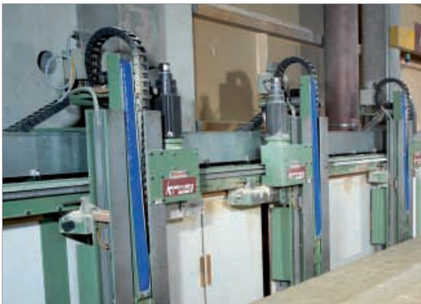
Système de chaîne porte-câbles de la série MONO sur machine à travailler le bois
