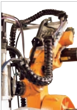
Système de chaînes porte câbles ROBOTRAX sur un robot à bras articulés Photo : SCA Schucker GmbH & Co.
