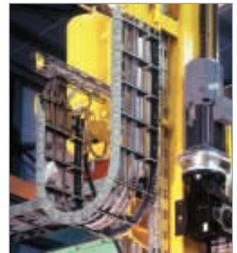
Système de porte-câbles ROBOTRAX et chaînes porte-câbles en acier sur une installation de manutention
