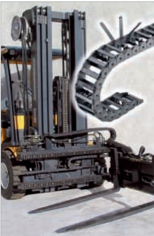
Système de chaîne porte-câbles de la série UNIFLEX sur chariot élévateur
