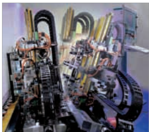
Chaînes porte-câbles série UNIFLEX sur installation automatique de pose (industrie du verre)
