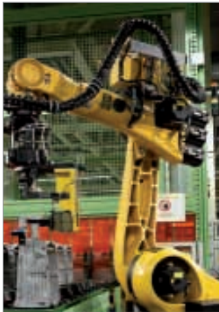
Système de chaînes porte câbles ROBOTRAX sur un robot à bras articulés Photos : Daimler Chrysler AG
