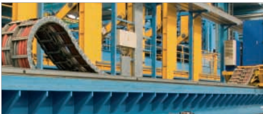
Système de chaîne porte-câbles en acier sur une machine à découpe laser Photos : Meyer Werft GmbH
