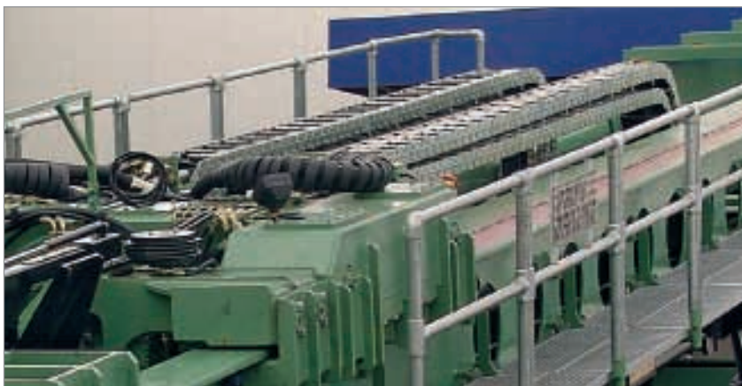
Chaînes porte-câbles en acier sur une machine de forage Photo : Prime Drilling GmbH
