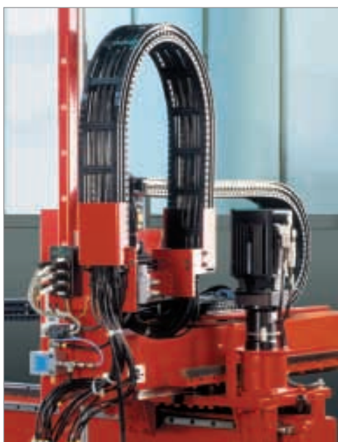
Système de chaînes porte-câbles QUANTUM sur une installation de manutention
