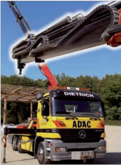
Système de chaîne porte-câbles des séries UNIFLEX et MONO sur camion de remorquage
