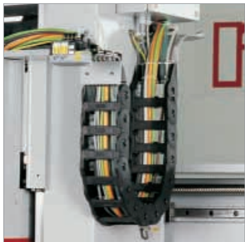
Chaînes porte-câbles série UNIFLEX sur un centre d'usinage à commande numérique
