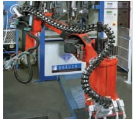
Ensemble porte-câbles ROBOTRAX : angle de rotation d'environ 180° sans chenal sur un robot à bras articulés Photos : Reis Robotics – Arthur Bräuer GmbH & Co. KG
