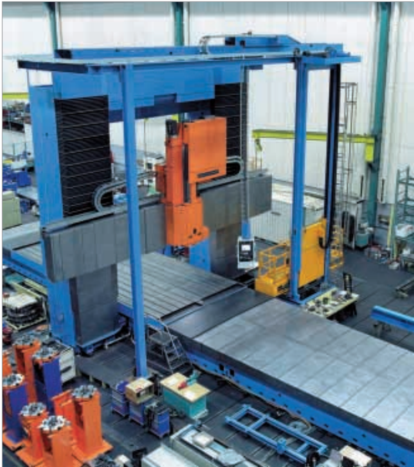
Système de chaîne porte-câbles en acier et en plastique ainsi que des protecteurs télescopique sur une machine de fraissage
