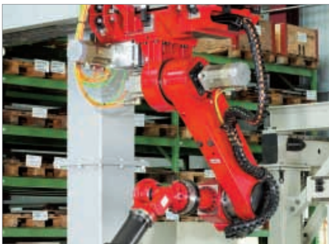
Ensemble porte-câbles ROBOTRAX sur une installation à portique et robot à bras articulés Photos : Güdel AG, Langenthal
