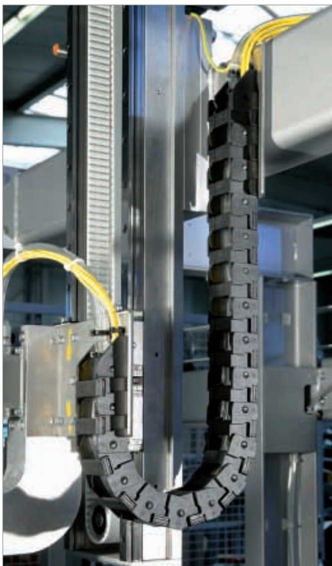
Système de chaîne porte-câbles de séries MONO et UNIFLEX sur un machine d'emballage
