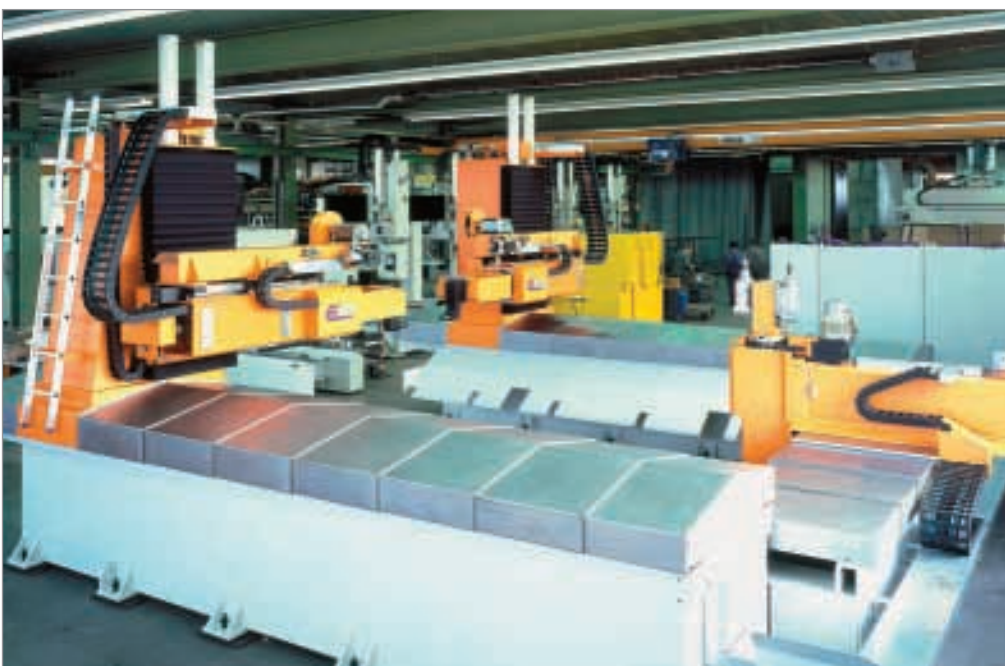
Chaînes porte-câbles de la série UNIFLEX et capotage télescopique Kabelschlepp sur un centre d'usinage haute vitesse
