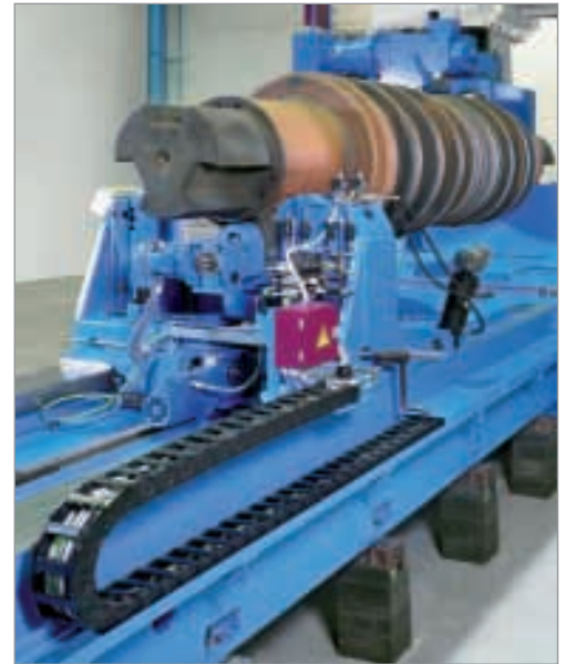
Système de chaîne porte-câbles des séries UNIFLEX et MONO
