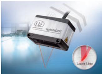
Les capteurs optoNCDT 1900LL de **Micro-Epsilon** sont conçus pour la mesure de distance sur les surfaces métalliques et structurées. Ces capteurs utilisent une petite ligne laser pour atteindre des mesures précises sur les surfaces
