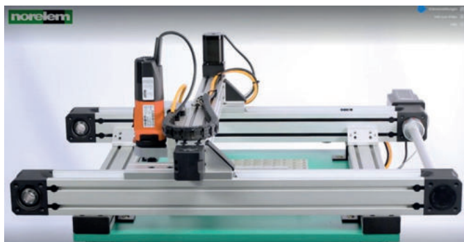
Les actionneurs linéaires avec entraînement par courroie crantée et guidage par rail profilé peuvent être utilisés pour une large gamme d'applications. La photo montre une fraiseuse à portique.
