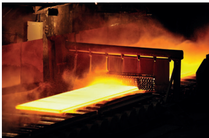
Exemple de train à chaud : une brame chauffée à blanc est transportée sur les rouleaux.
