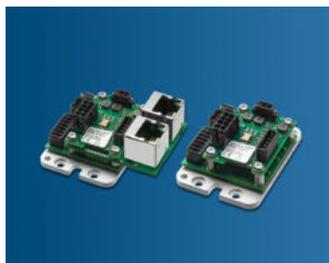
Faulhaber propose le MC3603, un contrôleur de mouvement compact et sans boîtier. Il est idéal pour l'intégration dans les applications de fabrication d'équipements et des technologies médicales. Avec 36 V et 3 A (courant de pointe : 9 A), il couvre la gamme de
